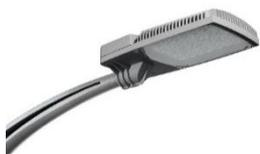
Luminária Pública de alumínio injetado sob alta pressão com protetor em vidro temperado e com acabamento em pintura eletroestática na cor padrão RAL 7040, com para encaixa lateral para braços com diâmetro de 42mm a 60mm possui integrado ao seu corpo aletas para a dissipação de calor permitindo controle e melhor gerenciamento térmico.
